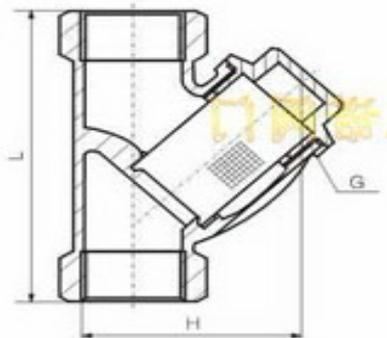
GL11H-16 内螺纹联接 Y 型过滤器主要应用于口径较小的管道设备,连接拆卸方便,排污性能可靠,经济适用。是输送介质的管道系统不可缺少的一种装置,通常安装在减压阀、泄压阀、定水位阀等水力控制阀或其它设备的进口端,用来清除介质中颗粒性杂质,免受因管道内杂质、铁锈、焊屑等带来的堵塞和损坏,从而避免了维修费用和生产损失,保护阀门等设备的正常使用。采用不锈钢双层网结构,坚固耐用,具有结构先进、流阻小、排污方便、纳污量大等等特点,主要用于水、蒸气等介质。当需要清洗时,只要将可拆卸的滤筒取出,去除滤出的杂质后,重新装入即可,使用维护极为方便。可根据客户需要设置过滤网的目数。
