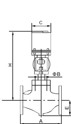
配361L执行机构电动阀外形图
